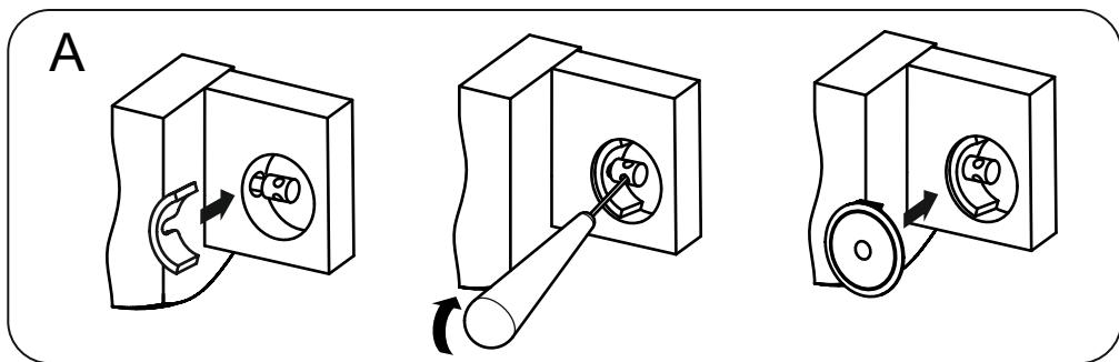
Порядок сборки сегментных стяжек: в отверстия царги 03 и 04 вставить сегменты и с помощью шила завернуть винты до упора. В отверстия вставить заглушки.
