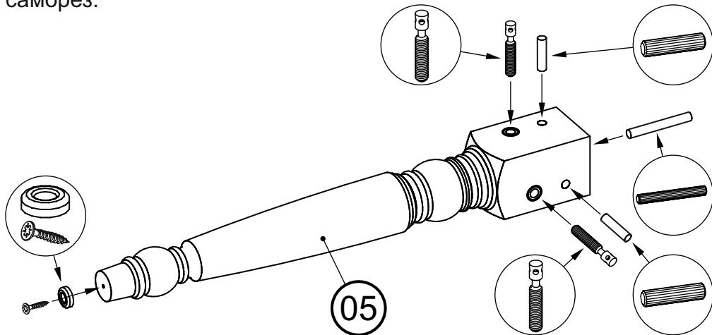
Соединить царги 03, 04 и опоры 05 между собой, совместив винты и шканты с отверстиями сопрягаемых деталей. Зафиксировать детали с помощью сегментных стяжек.
